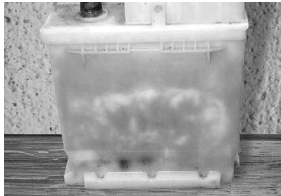
Figura 11 – Foto de uma bateria com descarga profunda com sulfatagem
